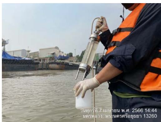
การเก็บตัวอย่างน้ำผิวดินสำหรับวิเคราะห์ BOD ด้วยเครื่องเก็บตัวอย่างน้ำแนวตั้งและขวดพลาสติก HDPE
