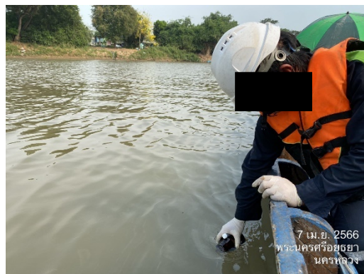
การเก็บตัวอย่างน้ำผิวดินสำหรับวิเคราะห์ดัชนีกลุ่มแบคทีเรีย
